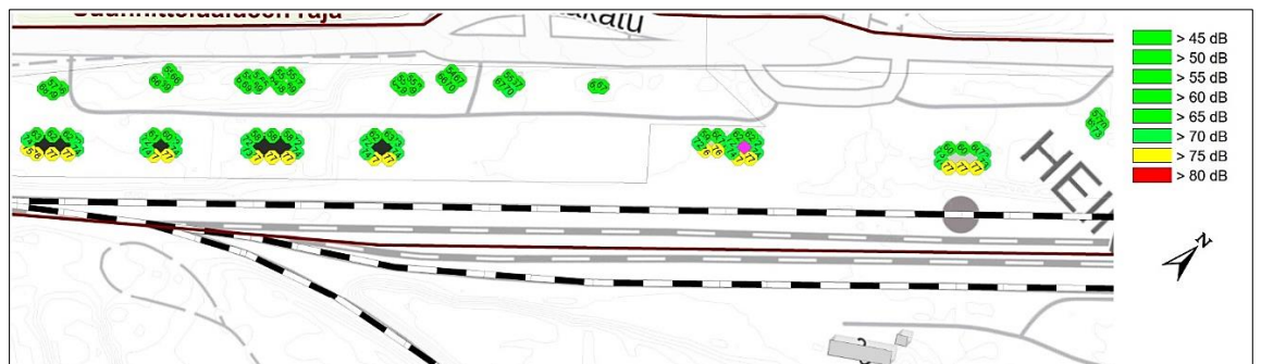
Kuva 5.2 Rautatieliikenteen julkisivuille aiheuttamat yöajan hetkelliset enimmäisäänitasot.
