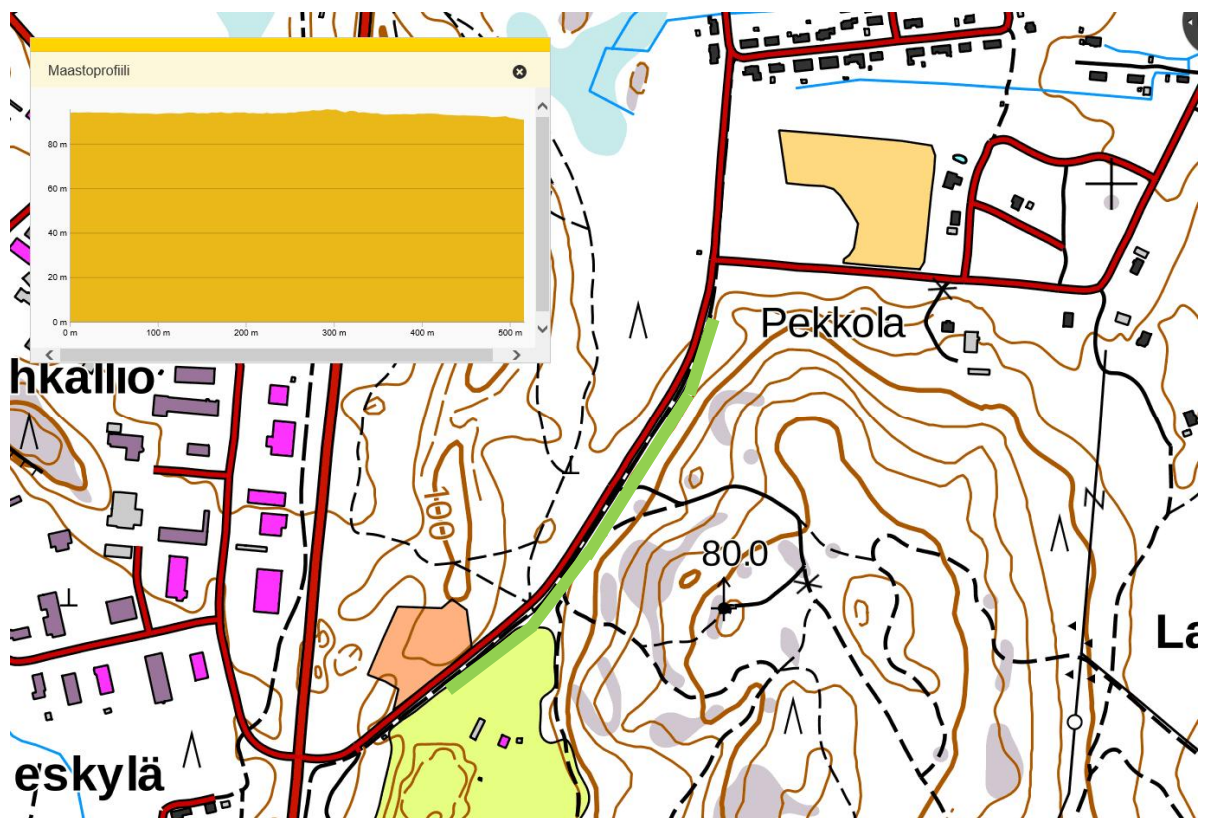
Kuva 5-14. Alustava hulevesiviemäriin sijainti varikkoalueelta Komostenkylän suuntaan ja maastoprofiili
